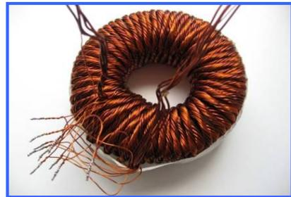
Рис. 1. Импульсный трансформатор с обмоткой из провода ЛЭП.
