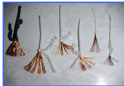
Рис.3. Провода марки ЛЭШО, ЛЭПШД, ЛЭПКО.
